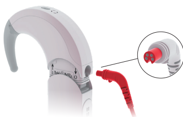
Fig. 27 Inserimento del cavetto della bobina nell'unità di controllo
