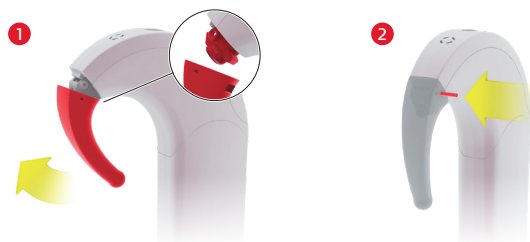
Fig. 33 Montaggio del supporto auricolare
