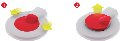
Fig. 21 Rimozione del magnete
