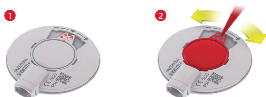
Fig. 17 Inserimento del magnete
